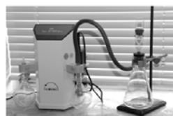
Abbildung 2: Aufbau für die Filtration bei der Nickel-Fällung
