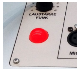
7. Live Streaming ist aktiv! Beachten Sie das Aufleuchten der roten Lampe. Diese signalisiert den Start der Live-Übertragung und/oder der Aufnahme. Drücken Sie „On / Off“ nach der Veranstaltung um den Live Stream zu beenden.
