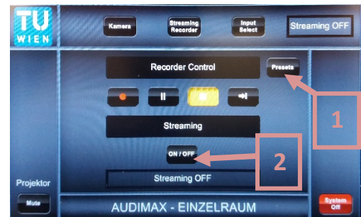
6. (optional) Gewünschtes Bildlayout mit „Presets“ wählen [1] und Live Streaming mit „On / Off“ starten [2]
