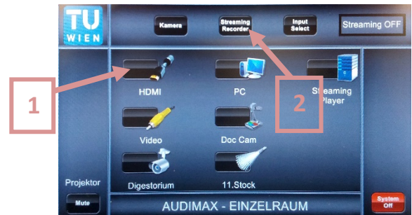
4. Gewünschte Quelle auswählen [1] und „Streaming Recorder“ [2] drücken
